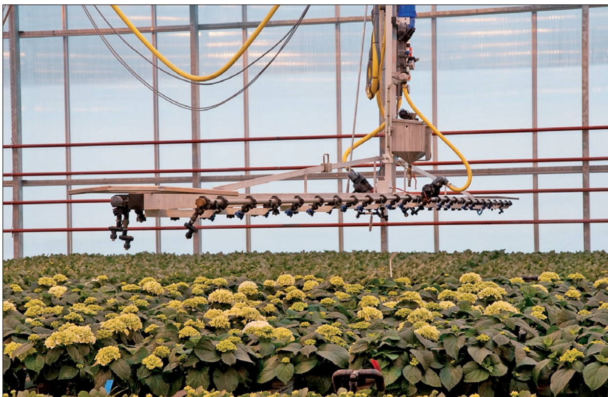
Figur 15. Sprøytebom. Foto: Erling Fløistad.
