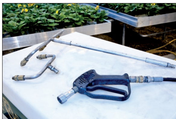
Figur 25. Eksempler på ulike dysekombinasjoner for sprøytepistol/-rifler. Foto: Erling Fløistad.
