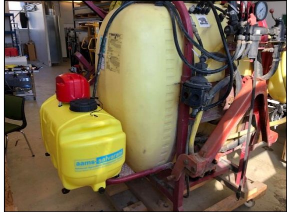
Figur 4: Skyllesystem ettermontert på en eldre sprøyte. Bildet viser et nytt system som har en egen elektrisk pumpe til rengjøring (rød boks). Det gjør at sprøyta kan rengjøres med et mindre væskevolum, og kontinuerlig fortynnes helt ned til rent vann. Skyllevannet renner ned i hovedtanken og sprøytes ut gjennom dysene med sprøyta's egen pumpe.. Systemet kan brukes både til innvendig skylling (spyledyse) og utvendig skylling (lanse) og er under utprøving ved REALTEK ved NMBU.
