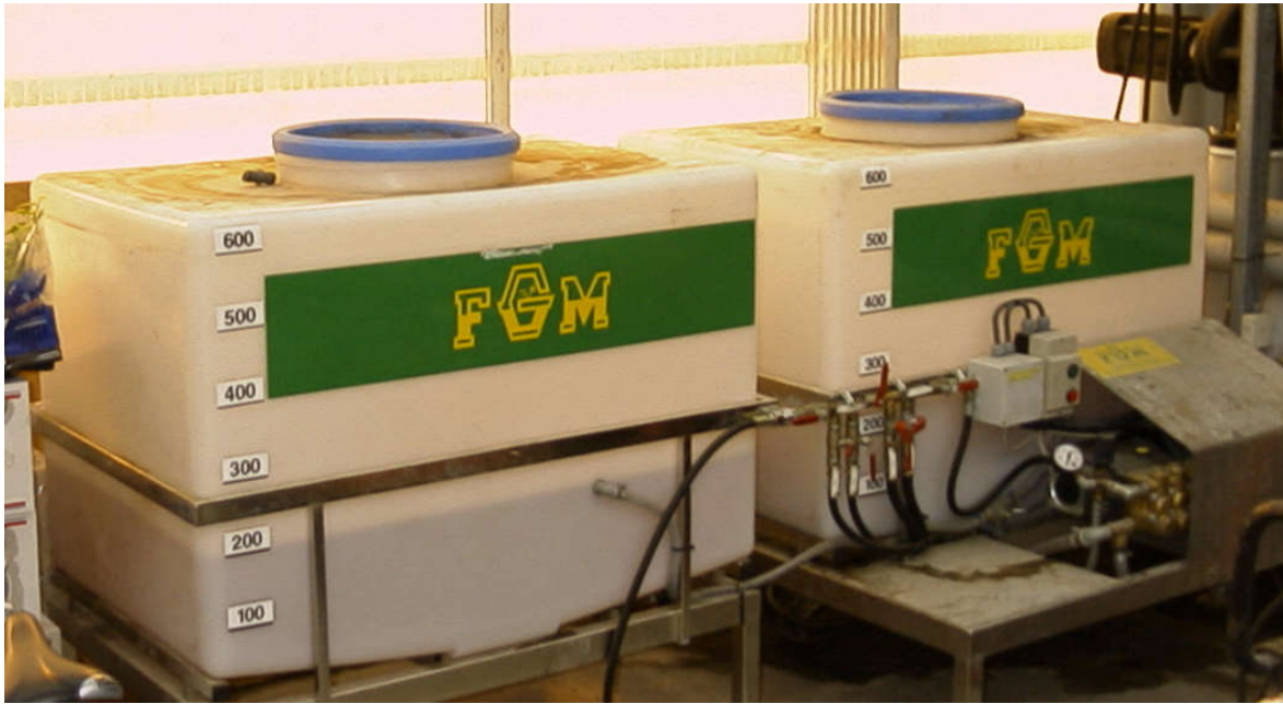
Figur 10 Faste tanker med slanger ut til en bevegelig bom (semi mobil). Det finnes enkelte steder hus med plantebord som flyttes under spredebommen som står fast (fast anlegg). Det er mest bruk av semi-mobile anlegg i veksthus i Norge.
