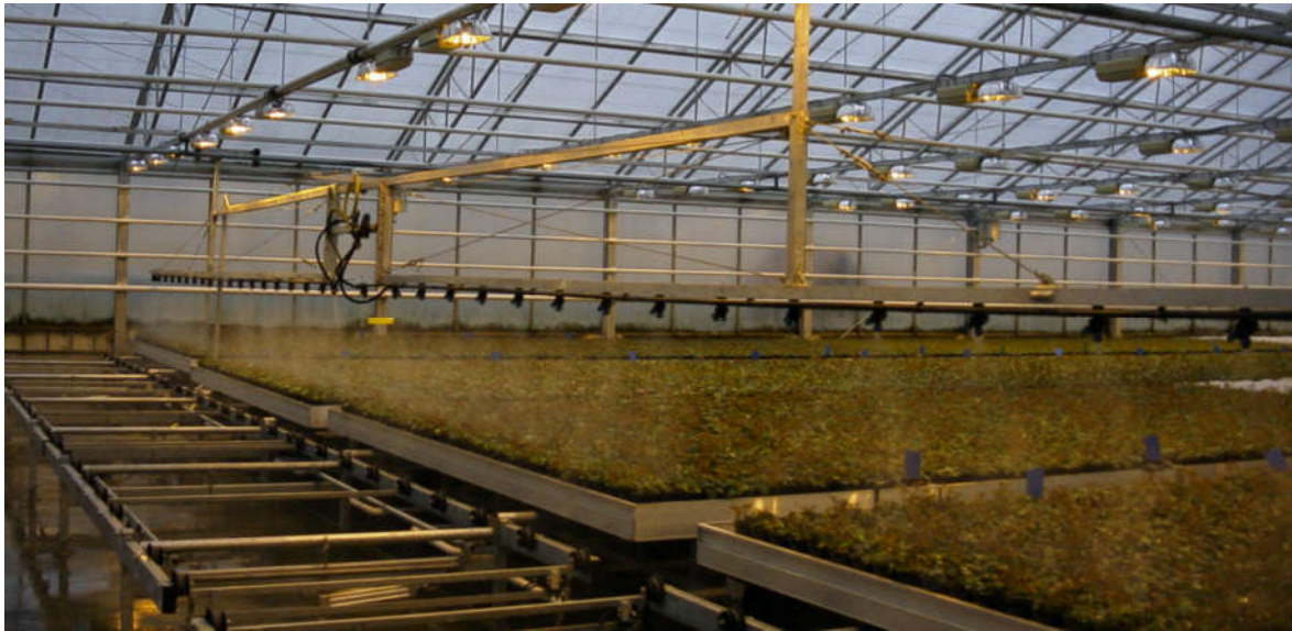
Figur 14 Spredebom egner seg i hus med tettdekkende og homogen plantestørrelse.
