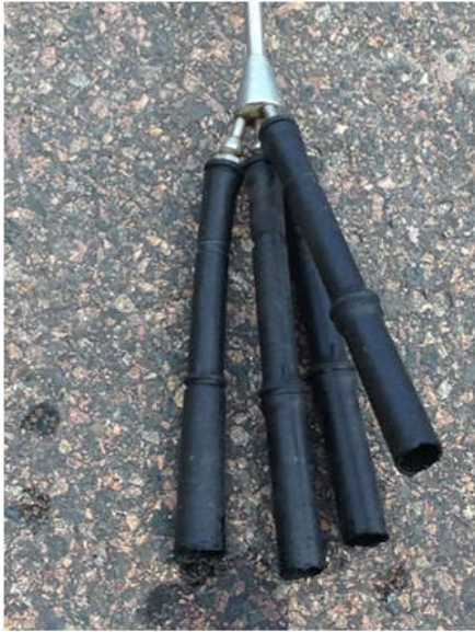
Figur 37 Ved å sette på spenekopper eller lignende kan en enkelt samle dysedusjen i en stråle som er lett å fange opp i målebeger. Her måles dysene på en rosett (foto: Mattilsynet)
