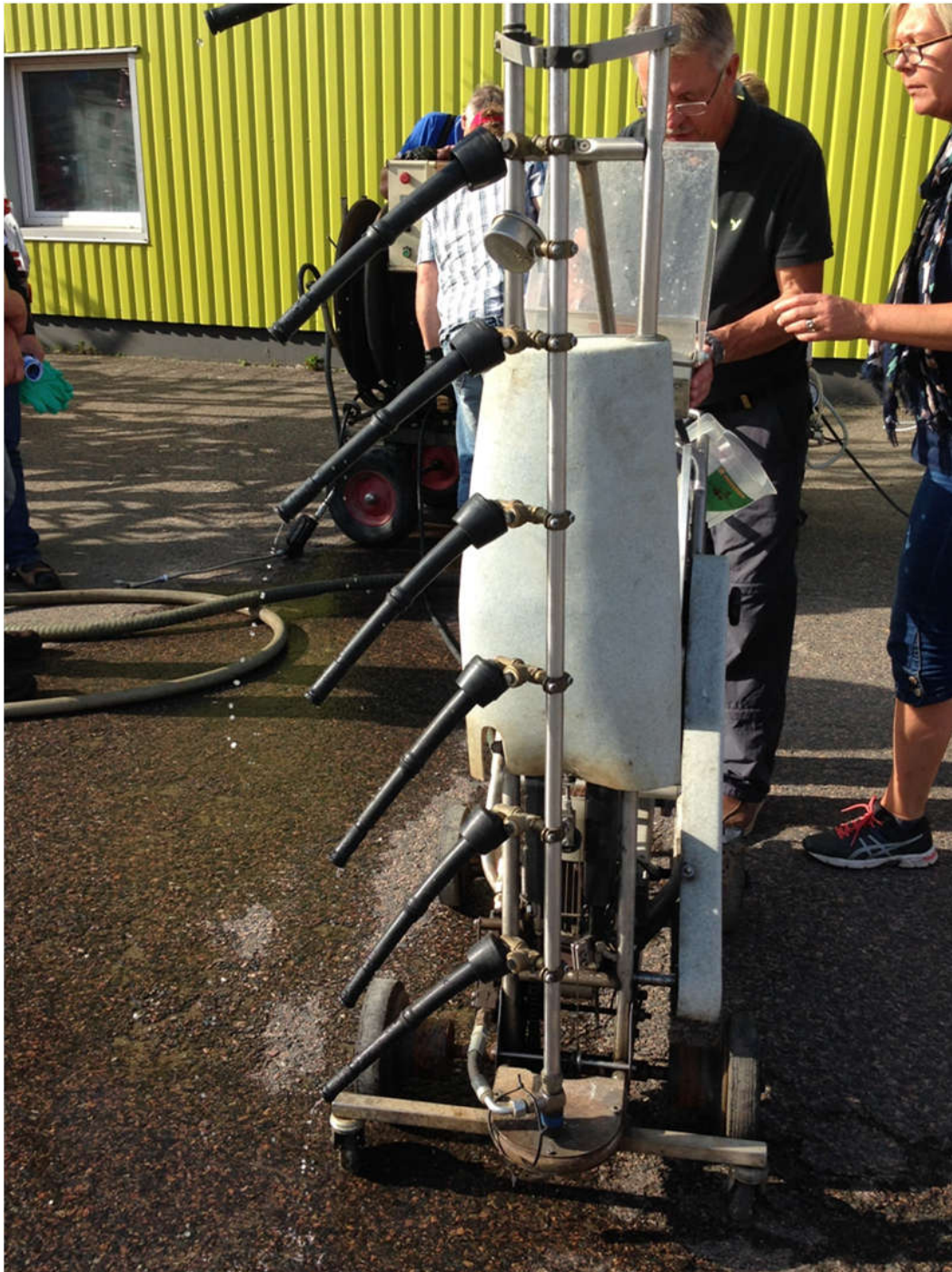
Figur 36 Ved å sette på spenekopper eller lignende kan en enkelt samle dysedusjen i en stråle som er lett å fange opp i målebeger. Her måles sprøytetårn til en side (foto: Mattilsynet)
