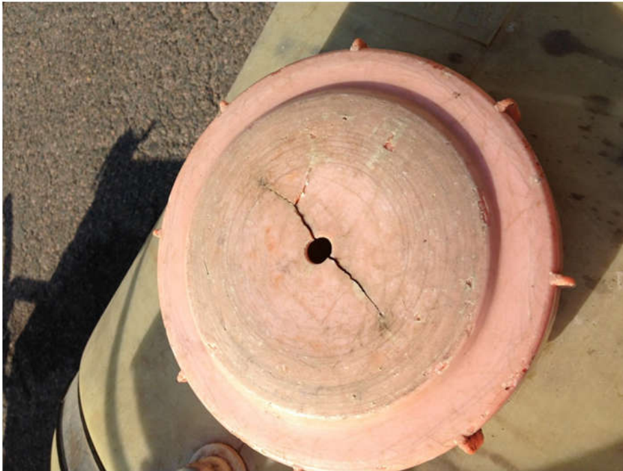
Figur 30 Det er ofte feil på lokk (Foto: Mattilsynet)
