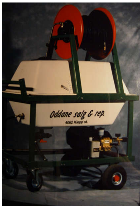
Figur 13 Det ble produsert noen slike enkle lavtrykksprøyter i Rogaland tidligere, med elektrisk drift (tankform etter gamle Erlandsprøyta)
