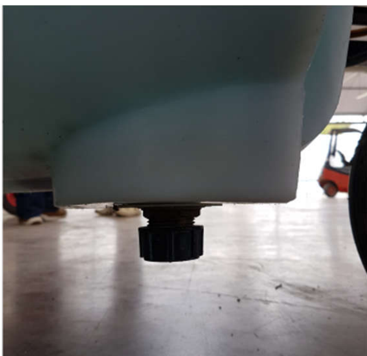
Figur 32 Ugunstig plassering av bunnplugg (vanskelig å tømme, krever store krefter og vanskelig å nå)
