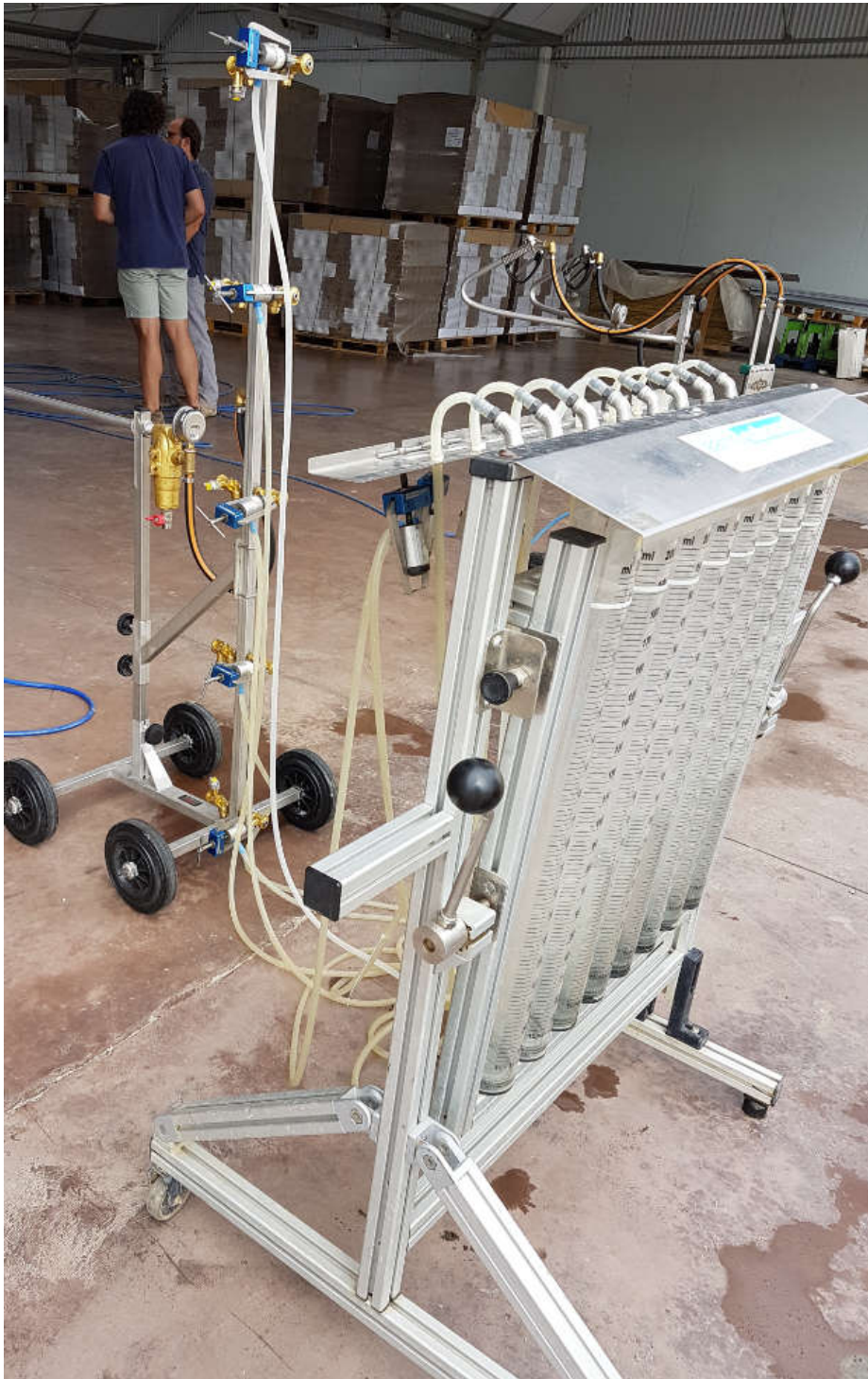
Figur 27 Sprøytetårn der dysekapasitet måles for alle dysene samtidig med måleutstyr fra aams.
