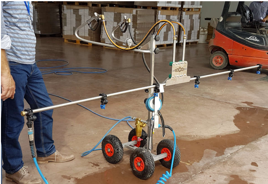
Figur 18 Det er laget mindre bommer som er mer fleksible og mye lavere kostnad. Men operatør kan lett bli utsatt for sprøytetåke
