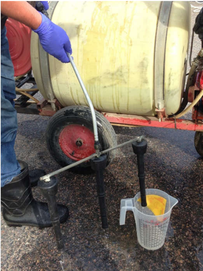
Figur 38 Ved å sette på spenekopper eller lignende kan en enkelt samle dysedusjen i en stråle som er lett å fange opp i målebeger. Her måles væsken fra en liten bom på tre dyser (foto: Mattilsynet). Brukes 3 målebeger, kan alle dysene måles samtidig.
