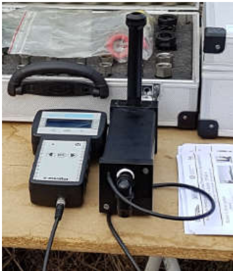
Figur 35 Måleutstyr for digital avlesing av dysekapasitet.
