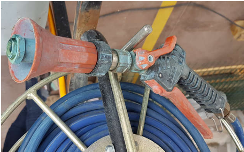
Figur 23 Det finnes mange varianter av sprøytepistoler/ -rifler, enkeltdyser, rosett, H-bjelker mm. Alle skal ha dødmannsknapp.
