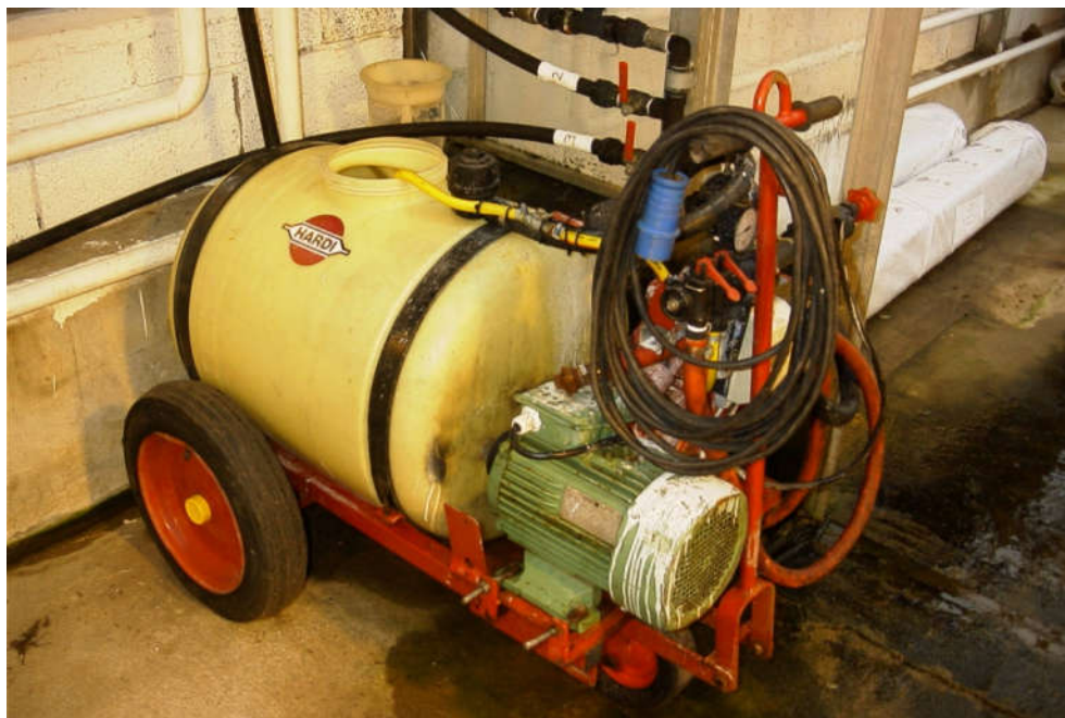
Figur 26 Avbryt testen dersom det synes å være feil med det elektriske anlegget! Sprøyta mangler også påfyllingslokk og silen ser ikke ut til å være mye brukt.
