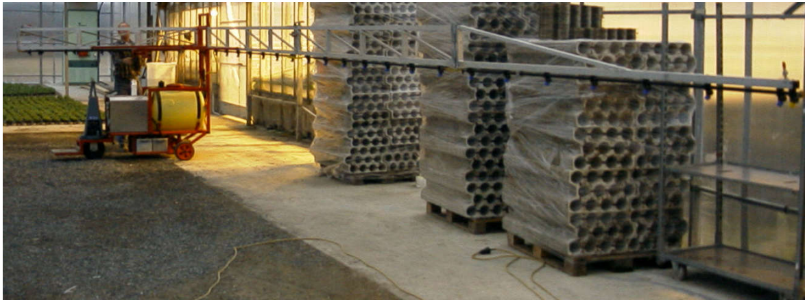
Figur 15 Spredebom på mobil enhet. Ved å sette på vekter, kan en sprøyte kun til en side.
