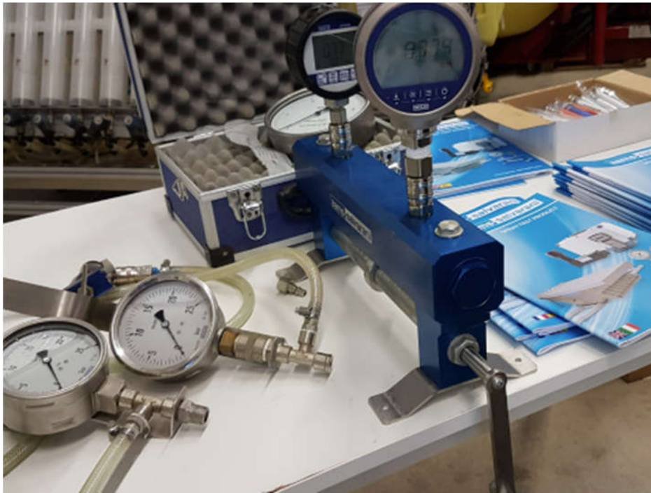
Figur 34 Måleutstyr for manometer og trykktap. Kontrollmanometeret har her digital skala.
