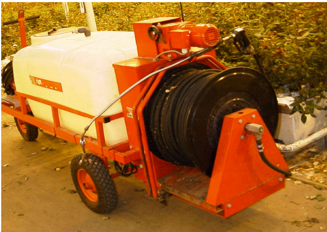
Figur 21 Sprøyte med motorinntrekk på slangetrommel. Den kan være fjernbetjent eller at en annen person overvåker inntrekket mens en annen sprøyter
