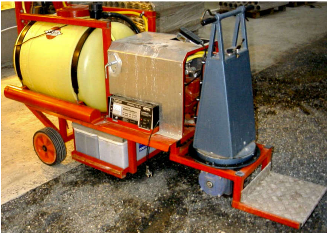
Figur 19 Spesiallaget mobil og elektrisk drevet sprøyte (batteridrift).
