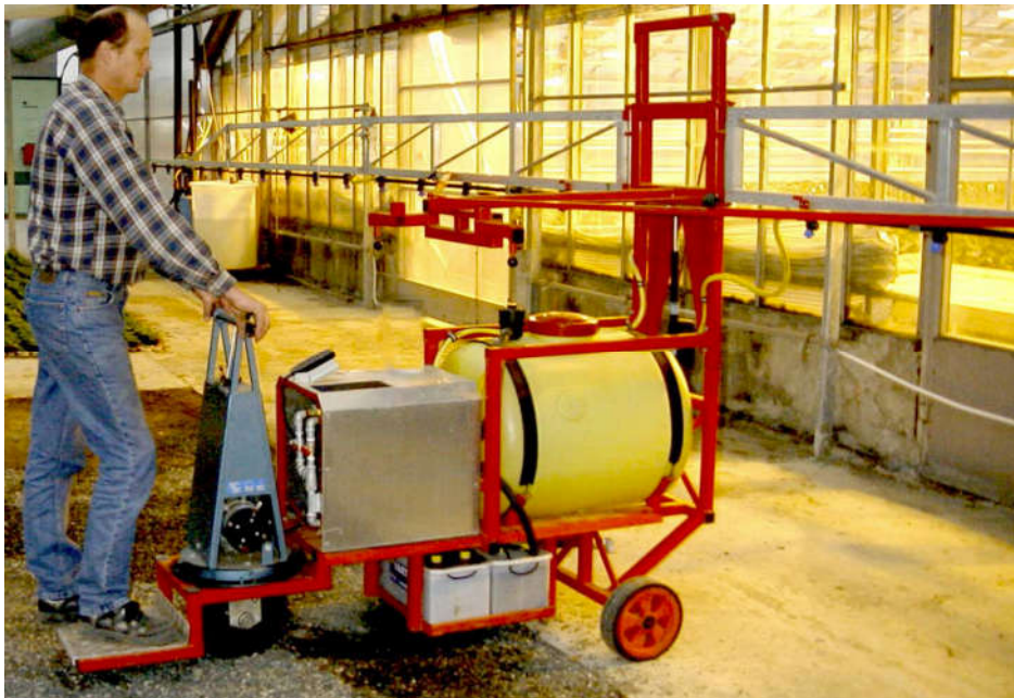
Figur 11 Eksempel på mobilt sprøyteutstyr i veksthus (både tank, pumpe og bom i en enhet). Det er sjelden, men finnes.
