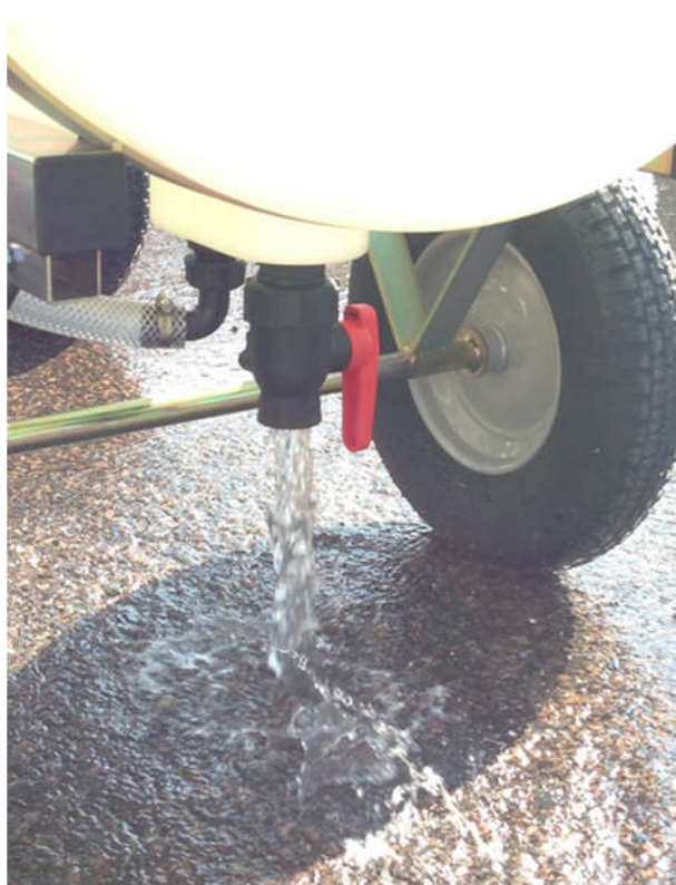
Figur 33 Bedre høyde og godt fungerende ventil for rask og sikker tømming av tank (foto: Mattilsynet)
