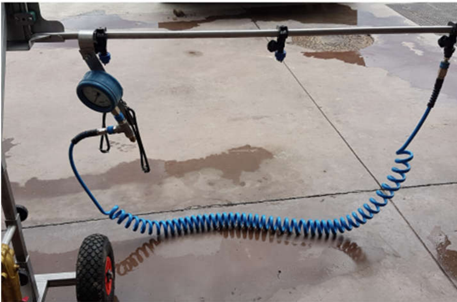
Figur 31 Trykktap måles over bommen ved å måle trykket ved tilføring og ved ytterste dyse. En spiralslange kan være praktisk å bruke.
